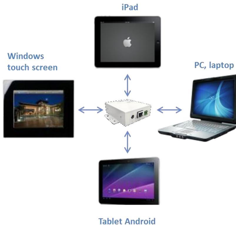
En la ilustración, se muestra una instalación típica del sistema theServa en una instalación basada en el estándar KNX. El miniservidor theServa se comunica con la instalación KNX a través de una interfaz KNX bipolar. La comunicación con otros dispositivos, como los transmisores de rayos infrarrojos, se realiza a través de Ethernet.
