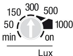
Con el mando a distancia del instalador se pueden ajustar los umbrales de luminosidad entre 5 y 3000 Lux.
