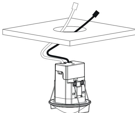
Montaje en falsos techos con un grosor de entre 0,5 mm y 3 cm, como máximo. El diámetro del orificio en el techo debe ser de entre 62 y 70 mm. No debe haber obstáculos entre el detector y las personas. La altura de montaje no puede ser inferior a 1.7 m o superior a 4 m.
