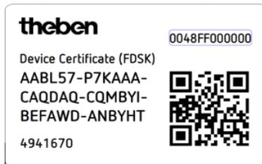
Tras introducir la FDSK, la ETS genera una clave de herramienta específica del aparato. La ETS envía a través del bus la clave de herramienta al aparato, que debe configurarla. La transmisión se codifica y autentifica con la clave FDSK original que se ha introducido anteriormente. Ni la clave de herramienta ni la FDSK se envían a través del bus en formato de texto.
