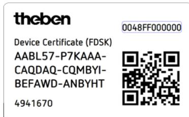
Tras introducir la FDSK, el ETS genera una clave de herramienta específica del aparato. El ETS envía a través del bus la clave de herramienta al aparato, que debe configurarla. La transmisión se codifica y autentifica con la clave FDSK original que se ha introducido anteriormente. Ni la clave de herramienta ni la FDSK se envían a través del bus en formato de texto. Tras la acción anterior, el aparato solo acepta la clave de herramienta para seguir comunicándose con el ETS.
