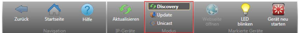
Klicken Sie auf die entsprechende Schaltfläche, um den Modus *Discovery*, *Update* oder *Unicast* auszuwählen. Die Funktion "Unicast" steht bei der Schnittstelle nicht zur Verfügung.
