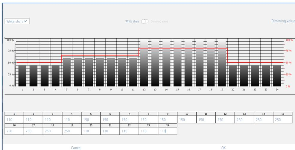
El gradiente de color o el gradiente de proporción de blanco y los valores de regulación de luz se ajustan del modo deseado arrastrando la barra en el gráfico o introduciendo los valores en la tabla.
