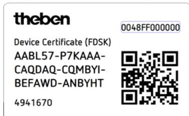
Tras introducir la FDSK el ETS genera una clave de herramienta específica del aparato. El ETS envía a través del bus la clave de herramienta al aparato, que debe configurarla. La transmisión se codifica y autentifica con la clave FDSK original que se ha introducido anteriormente. Ni la clave de herramienta ni la FDSK se envían a través del bus en formato de texto.
