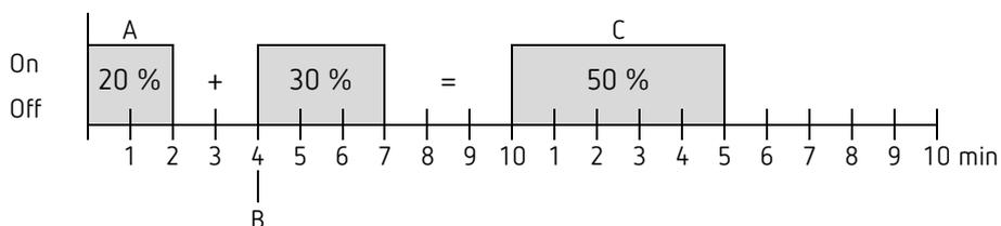
**i** Si en el momento de la recepción de una nueva magnitud de ajuste ya se ha excedido el nuevo tiempo de conexión nominal para el ciclo actual, se desconecta inmediatamente la salida y la nueva magnitud de ajuste se aplica en el próximo ciclo.
