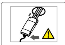
➤ Pasar el dispositivo de potencia a través del orificio en el techo y fijar el sensor al techo con resortes tensados
